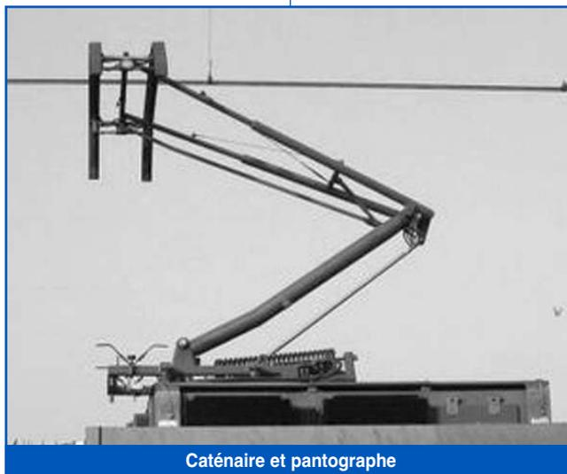
Caténaire et pantographe
