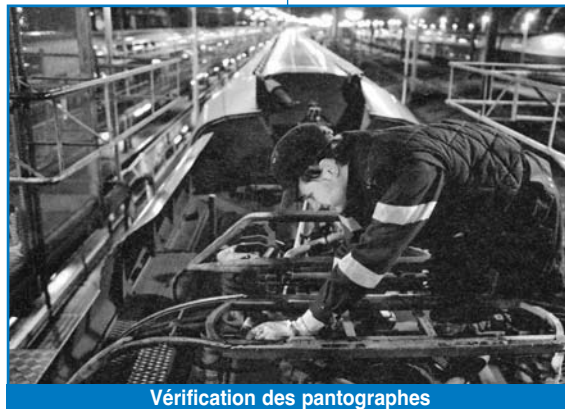
Vérification des pantographes
